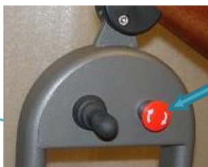
PARAGEM DE EMERGÊNCIA
